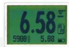
Pantalla de medición: Dígitos grandes, Valor Min., Unidad, Indicador de batería
